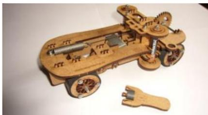
Hybridauto, genau genommen ein Hybridporsche, der ursprünglich auch für Porsche entwickelt wurde, zusammengebaut. Dieses Auto hat einen elektrischen und einen mechanischen Antrieb über eine Feder. Jedes der vier Räder hat einen Freilauf, so dass das Auto entweder mit dem mechanischen Antrieb, dem elektrischen Antrieb oder beiden Antrieben gleichzeitig bewegt werden kann. Das Hybridauto kann am Ende mit nach Hause genommen werden und es wird gewährleistet, dass jedes auch funktioniert.
